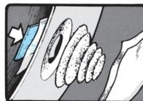
4. Schrägen Sie den Rand des Lochs an, um eine größere Fläche des Laminats freizulegen und so eine bessere Verbindung zu erzielen. Eine Schräge von 12 bis 25 facher GFK-Stärke ergibt eine verbesserte Klebefläche für die Reparatur und somit beste Haftung.
