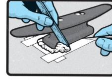
6. Positionieren Sie den Beschlag und ziehen die Schrauben an, bis etwas Epoxy-Mischung an der Seite heraustritt. Nicht zu fest anziehen. Benutzen Sie Wachs oder Trennmittel an den Bolzen, wenn Sie eine lösbare Verbindung wünschen.
