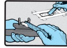
4. Beschichten Sie beide Klebeflächen mit klarem Epoxidharzgemisch. Tränken Sie die Innenseite der Befestigungslöcher mit einem epoxygetränkten Pinsel oder injizieren Sie das Epoxy mit einer Spritze.
