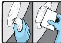
6. Schneiden Sie Gewebeflicken von abgestufter Größe, bis die gewünschte Laminatstärke erreicht wird.
