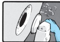
3. Ist das Loch größer als 25 mm im Durchmesser, also strukturell bedeutend, dann folgen Sie den nachstehenden Anweisungen und verwenden das 450g/m<sup>2</sup> Gewebe.
