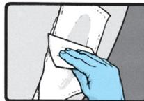
5. Falls erforderlich, kann man die Reparaturstelle von hinten mit einem in eine Plastikfolie gepackten Stück Sperrholz verschließen. Die Rückplatte kann provisorisch zum Beispiel mit einem Stab eingeklemmt werden.
