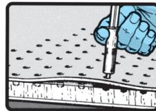
3. Der Kern muss vor dem Wiederverkleben sorgfältig getrocknet werden. Man kann in das Laminat Löcher von 6mm Durchmesser im Abstand von 25mm und bis etwa 75 mm außerhalb der Delaminierung bohren. Man bohrt durch das Laminat auf etwa 1/3 der Dicke des Kerns tief.
