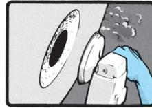
3. Perfile el borde del agujero para dejar al descubierto el laminado sólido, exponga suficiente superficie para asegurar una adherencia óptima. Un perfil equivalente a la vigésima parte del grosor total del laminado de GRP, proporciona suficiente área para la nueva reparación.
