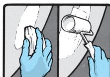
7. Cubra la reparación con Peel Ply, añadiendo más epoxi para empapar el Peel Ply, si resulta necesario, deje curar.
