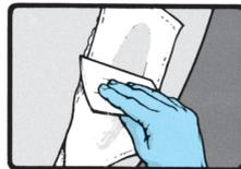
5. Corte discos de tejido, escalonando los tamaños hasta alcanzar el espesor de laminado deseado.
