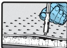
3. Es imprescindible que el área deslaminada esté completamente seca antes de realizar la reparación. Perfore orificios de 6mm, separados por 25mm y alrededor de 75mm del borde exterior del área a tratar. Taladre a través de la capa desprendida, penetrando ligeramente en el casco.
