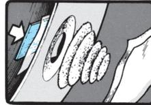
4. Si resulta necesario, coloque tablero marino recubierto de plástico en el interior del agujero.
