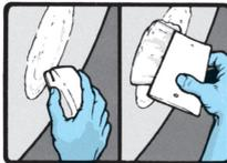
5. Si nécessaire, renforcez le stratifié à l'aide d'une contre plaque appliquée derrière.
