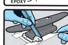
6. Positionnez les pièces et pressez jusqu'à ce que l'époxy déborde. Ne pas mettre sous contrainte. Appliquez de la cire ou de l'huile sur les vis afin que l'époxy ne puisse adhérer et insérez le en tournant dans le sens du vissage.
