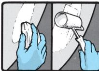
6. Couper des disques de tissu de plus en plus grands (différence +1cm de rayon) jusqu'à la stratification complète. Vous stratifierez toujours du plus grand disque au plus petit.
